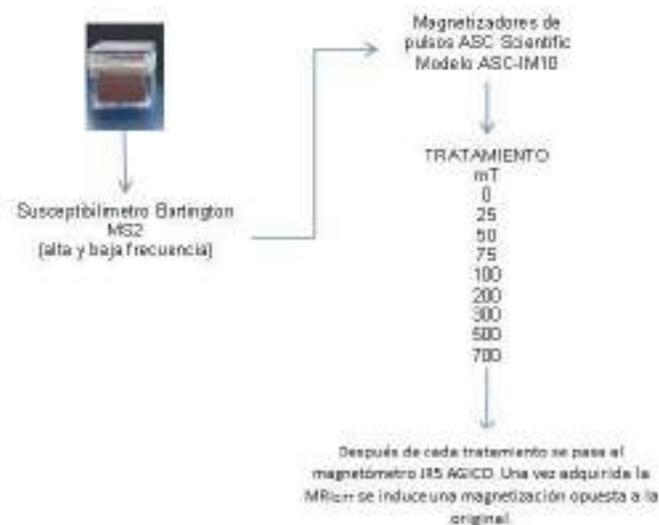
Figura 20. Diagrama de las técnicas empleadas para la caracterización magnética
