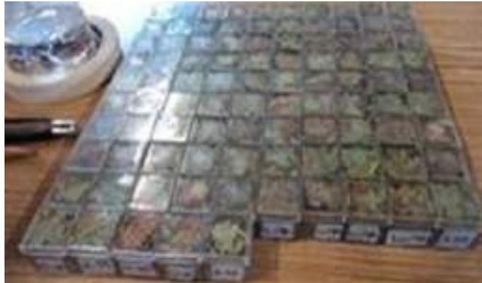
Figura 19. Cubos porta muestras para mediciones magnéticas. Con dimensiones interiores de  $2 \times 2 \times 2 \text{ cm}$  ( $8 \text{ cm}^3$ )
