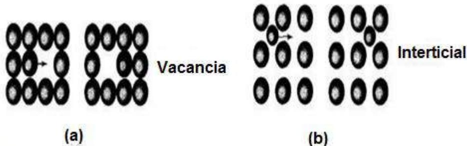
**Figura 2.3.** Esquema representativo de un arreglo tridimensional de átomos donde existe (a) vacancia y (b) átomos intersticiales <sup>[111]</sup>.
