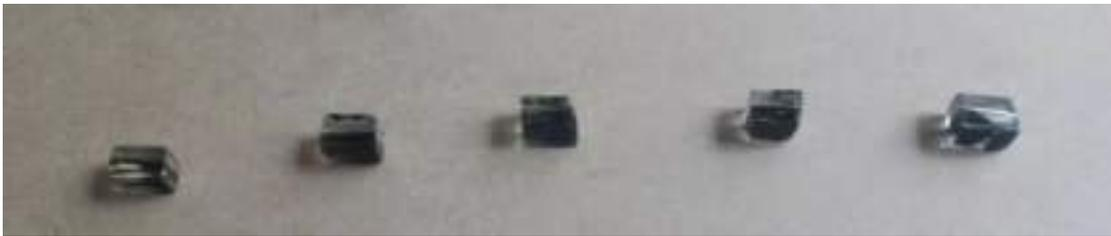
**Figura 1.14.** Montaje de las muestras metálicas de acero IF quienes recibieron diferentes tiempos de tratamientos termomecánico a una temperatura constante de 780 °C.
