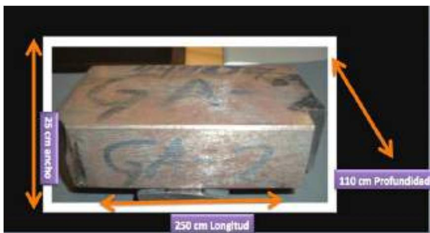
*Figura 1.8. Planchón de acero IF después de la colada continua.*
