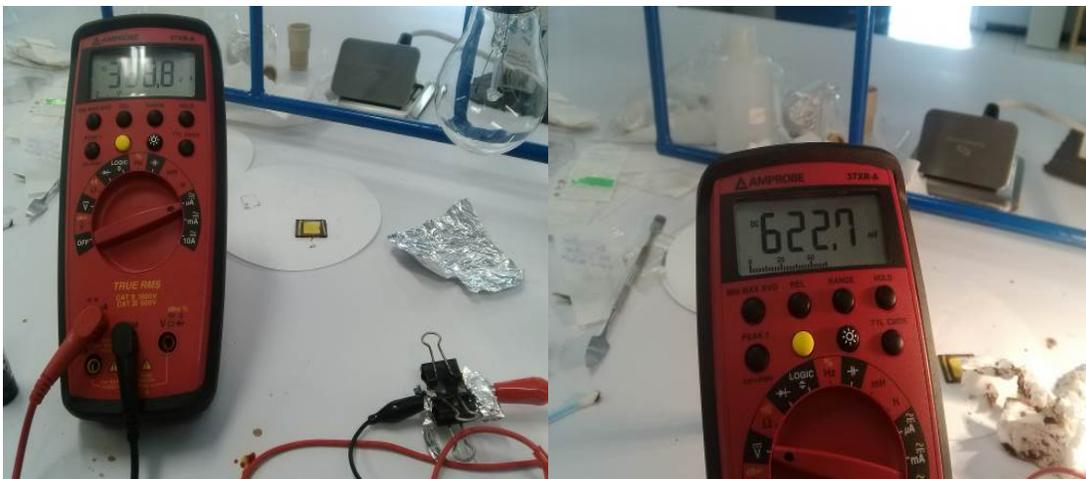
**Figura 2.19.** Mediciones eléctricas de celdas solares tipo Grätzel.
