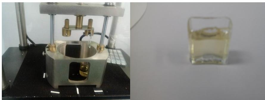
**Figura 2.2.** (a) Aparato de dip coating para la preparación de películas delgadas y (b) Solución de TiO<sub>2</sub>.
