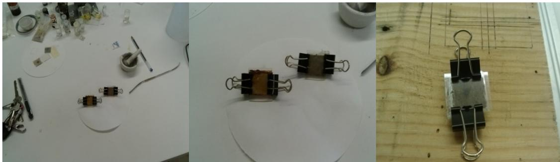
**Figura 2.14.** (a), (b) y (c) Prototipos de celdas  $TiO_2$  tipo Grätzel en vidrio.
