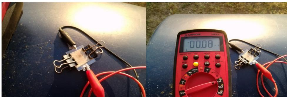
**Figura 2.12** Celdas solares con electrodo de película de  $\text{TiO}_2$  gruesa siendo examinadas en la luz solar.
