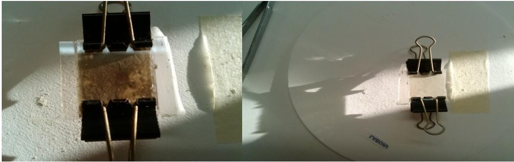
**Figura 2.13.** Prototipos de celdas solares DSSC con película gruesa de  $TiO_2$  y contraelectrodo de óxido de grafeno.
