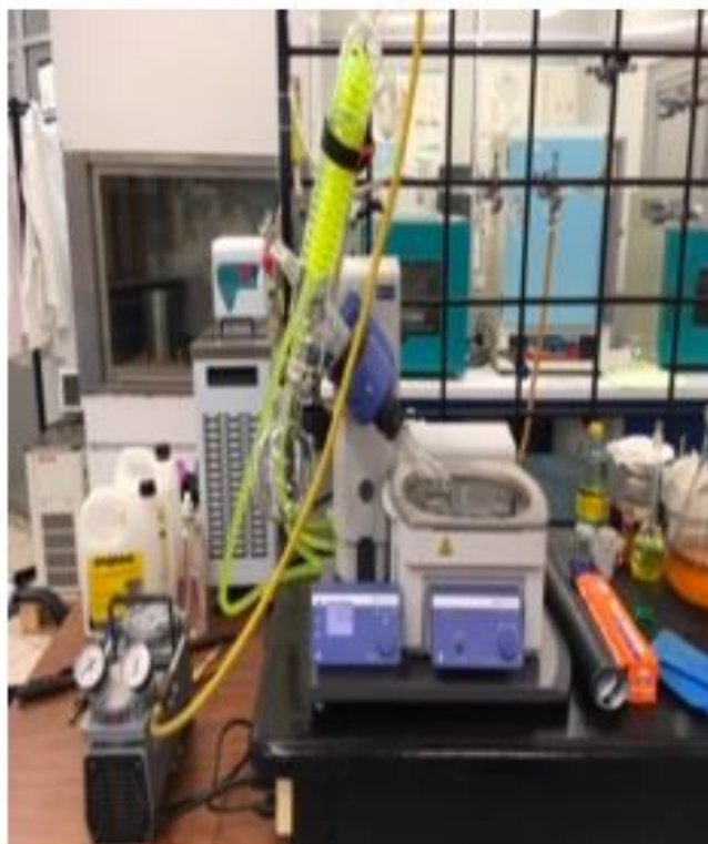
Figura 48- Arreglo experimental del proceso de destilación.
